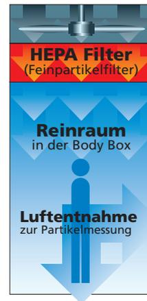
In der Body Box wird die Menge der Partikel, die beim Tragen unterschiedlicher OP-Bekleidung freigesetzt wird, gemessen: Die einströmende Luft ist gefiltert (partikelfrei), von der ausströmenden, beladenen Luft werden Proben genommen und die koloniebildenden Einheiten (KBE) von Bakterien ermittelt.
